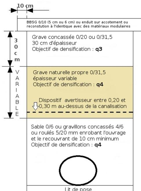
Si la tranchée ne peut être implantée à une distance au moins égale à sa profondeur (distance du bord de chaussée), la partie inférieure de remblai sera réalisée avec un compactage dont l'objectif de densification est q3 pour les 60 cm supérieurs de remblai. Au-delà de 60 cm, l'objectif de compactage est q4 avec réemploi possible des matériaux en place.
