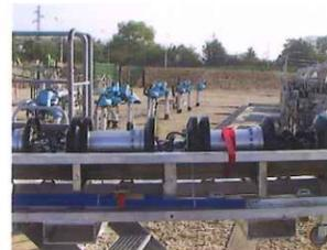
Ces racleurs sont munis de capteurs qui permettent de contrôler l'état des parois des tubes.
