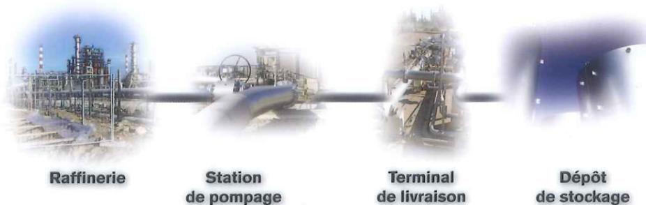
Le réseau SPMR constitué de canalisations enterrées à 80 cm au moins, est équipé de stations de pompage pour la progression des produits pétroliers et de terminaux de livraison pour la distribution des produits transportés vers les dépôts de stockage.
